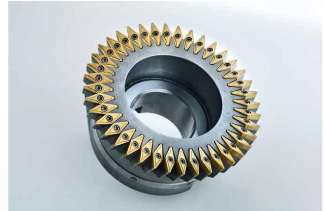
Großes Bild: zylindrisches Schälwerkzeug
